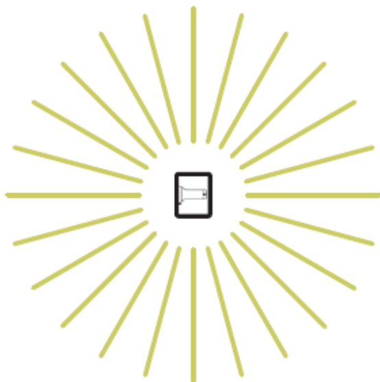
FIGURA 5 Cobertura omnidirecional típica do AP, vista da parte superior - Cobertura do plano de azimute
