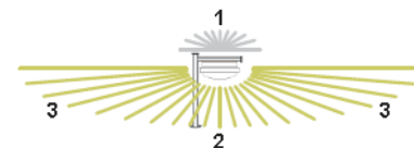
FIGURA 2 Cobertura omnidirecional típica do AP, vista lateral - Opção 1
